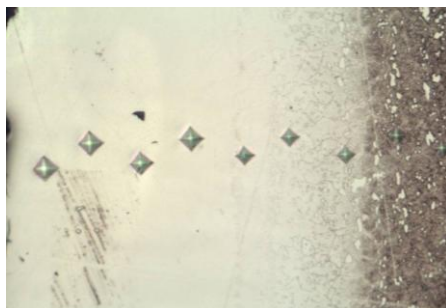
Рисунок 12. – Микроструктура зуба червячной фрезы с результатами замеров микротвёрдости (увеличение \times 200)
