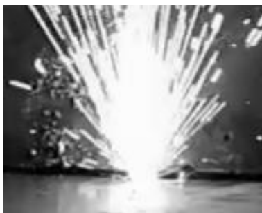
Рисунок 11. – Фотография процесса импульсной лазерной термообработки металла с оплавлением поверхности (наплавка)
