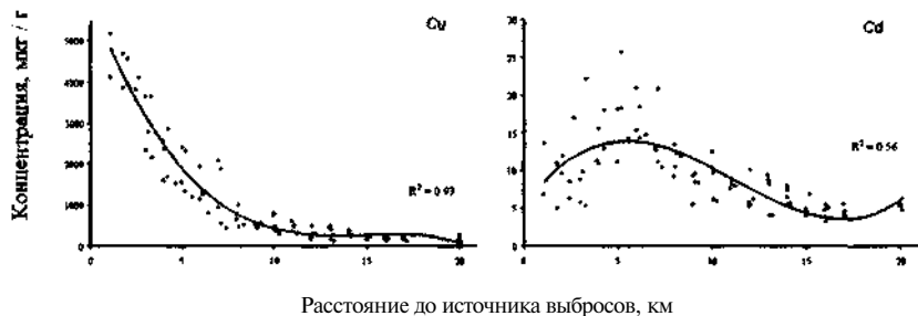
Рис. 5. Зависимость содержания тяжелых металлов в лесной подстилке от расстояния до источника выбросов (СУМЗ). Линии - аппроксимации параболой третьей степени. Учетная единица - площадка, сбор проведен в 1990 г. в западном направлении от завода (полоса шириной 5 км).
