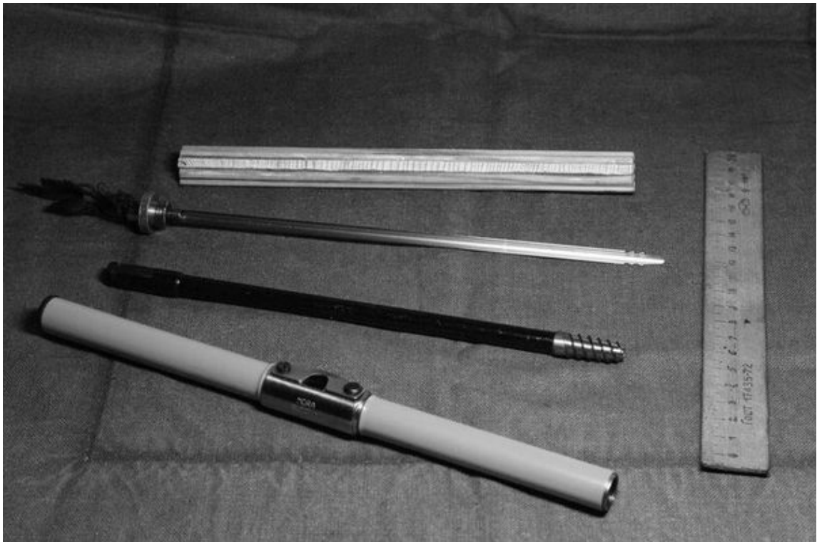
Рис. 2. Возрастной бур «Naglof» с экстрактором
