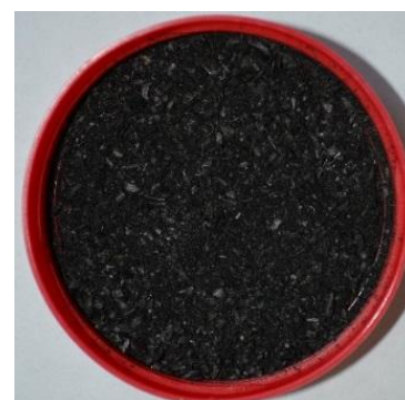
Рис. 2. Пиролиз лузги подсолнечника: а – материальный баланс процесса; б – фотография твердого углеродистого остатка
