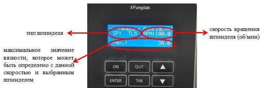
Рис. 8. Интерфейс “Measurement”. Основные функции измерения вязкости
