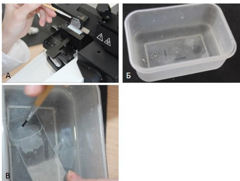
Рис. 3. Этапы получения парафиновых срезов.
