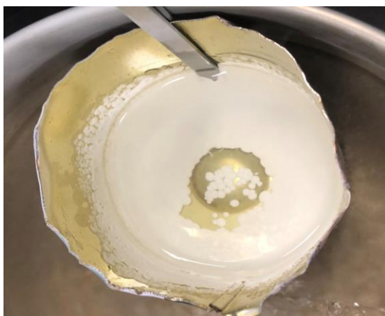
Рис. 1. Изопентан, охлажденный в жидком азоте до появления кристаллов
