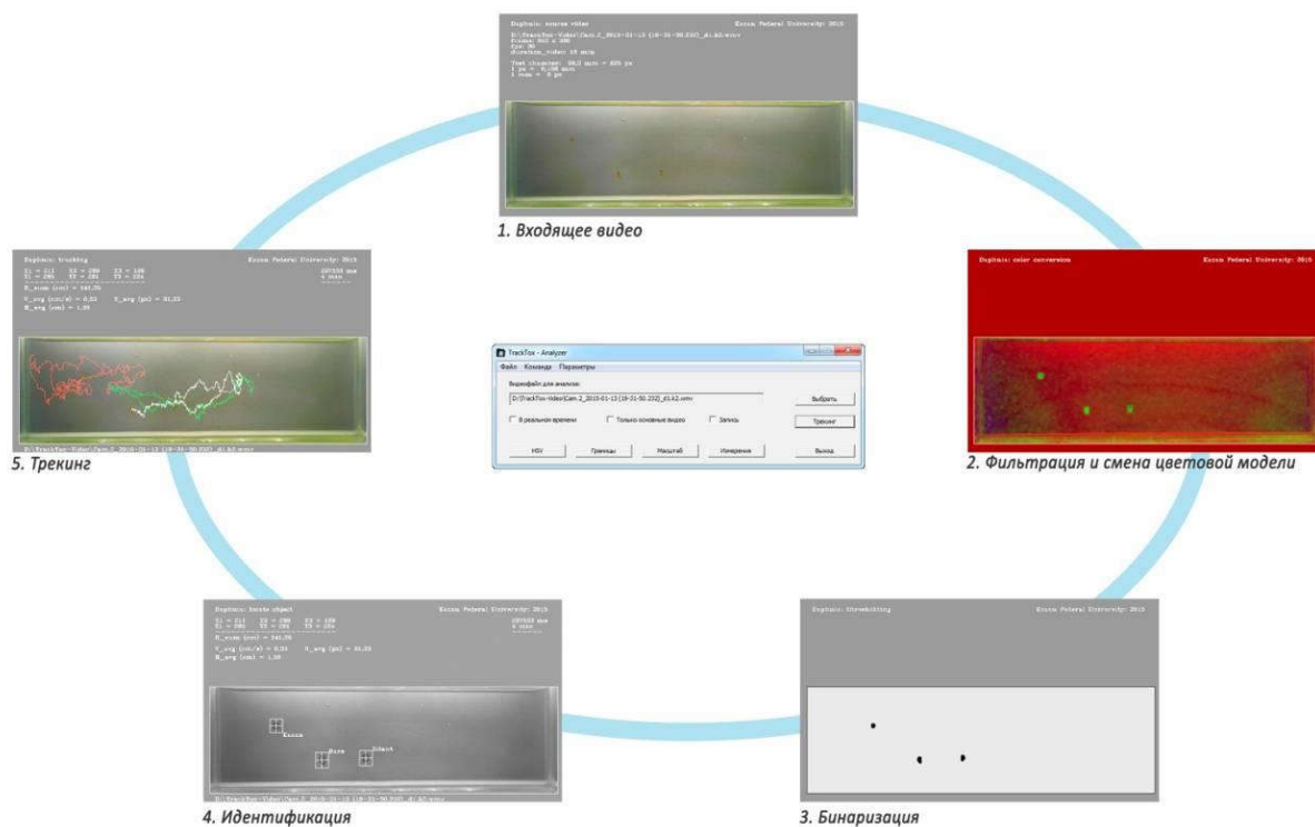
Рис. 1. Алгоритм обработки видео с дафниями
