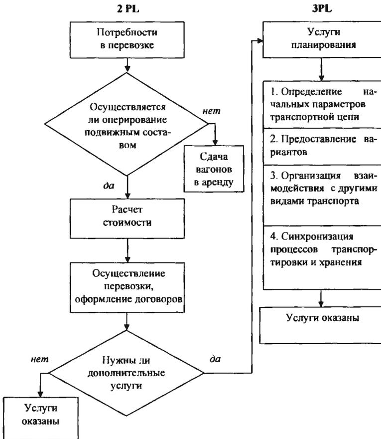
**Рисунок 4 – Алгоритмизированная схема предоставления транспортно-логистических услуг российскими грузовыми операторами железнодорожного транспорта<sup>1</sup>**
