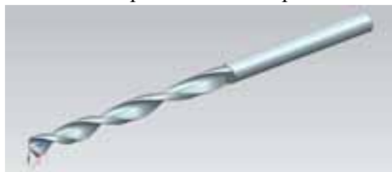
Рис. 3. Модель сверла с переменным углом винтовой канавки
