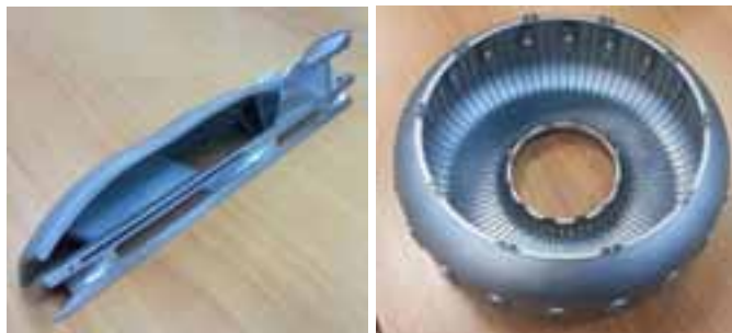
Рис. 4. Детали авиационного двигателя, полученные промышленным методом с помощью технологии селективного лазерного сплавления
