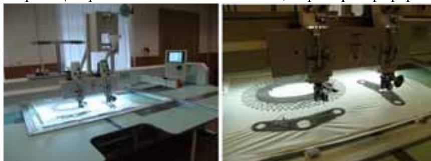
Рис. 1. Оборудования для изготовления преформы методом TFP
