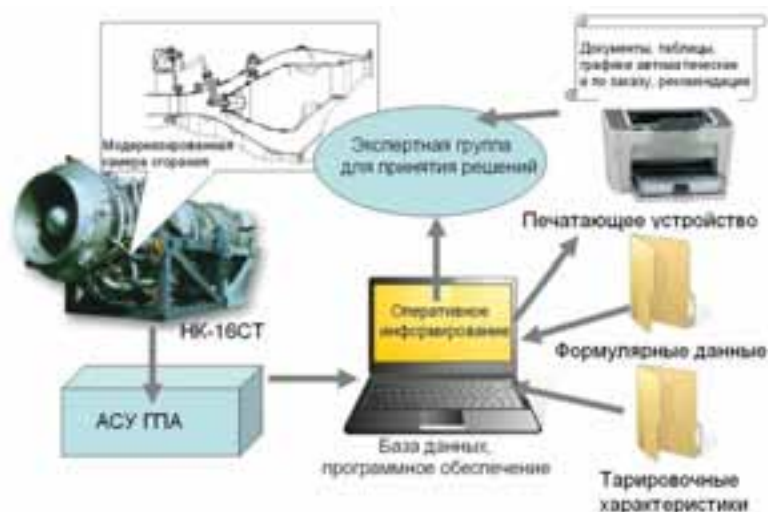
Рис. 4. Информационная схема автоматизированной системы диагностики для ГТД НК-16СТ с модернизированной камерой сгорания
