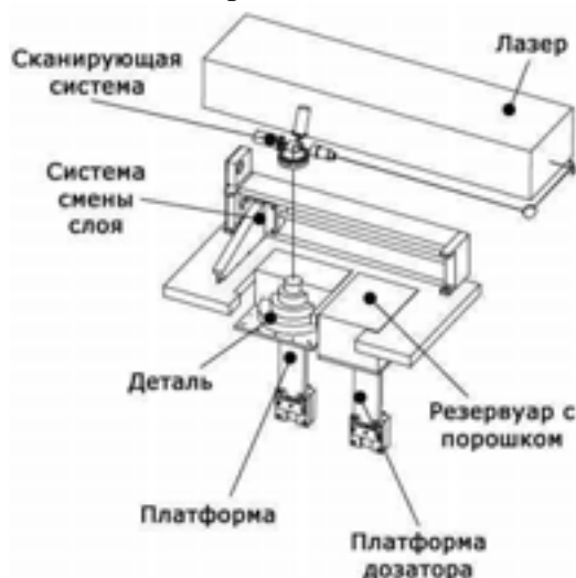
Рис. 1. Схема процесса лазерного спекания
