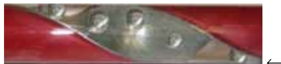
Рис. 5. Фотография пробкового режима течения в канале со скрученной лентой
