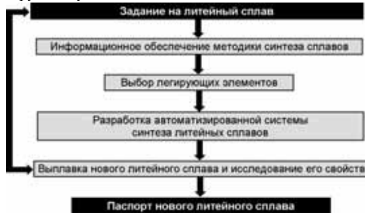
Рис. 1. Схема методики синтеза литейных сплавов
