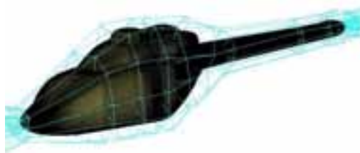
Рис.2. Элементы расчетной сетки
