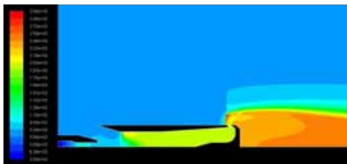
Рис.7. Поле температур в эжекционной горелке
