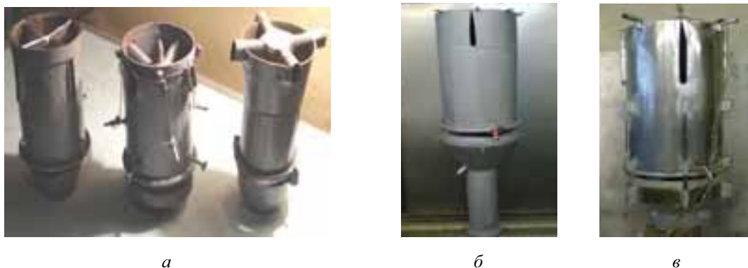
Рис. 6. Исследуемые эжекторы с наружным диаметром камеры смешения: а – 0,06 м; б – 0,27 м; в – 0,42 м
