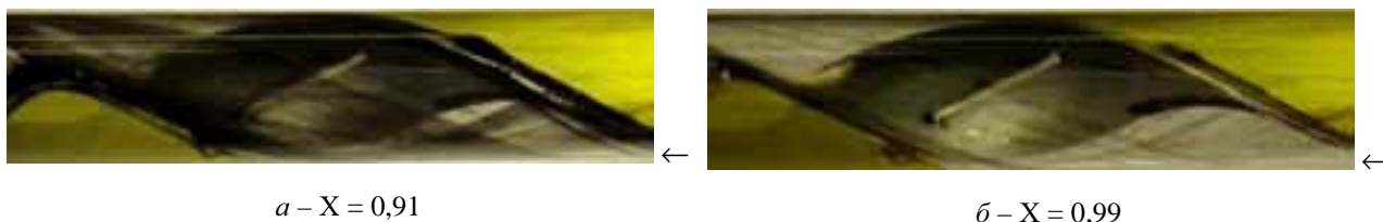
Рис. 11. Фотографии двухфазных течений в трубе со скрученной лентой с ребрами на ее поверхности, расположенными под углом к оси ленты против направления ее скручивания (жидкость подкрашена темной краской, половина канала заглушена): G = 14,5 г/с, p = 0,15 МПа, s/d = 3 , высота ребер 1 мм, шаг между ребрами 18 мм
