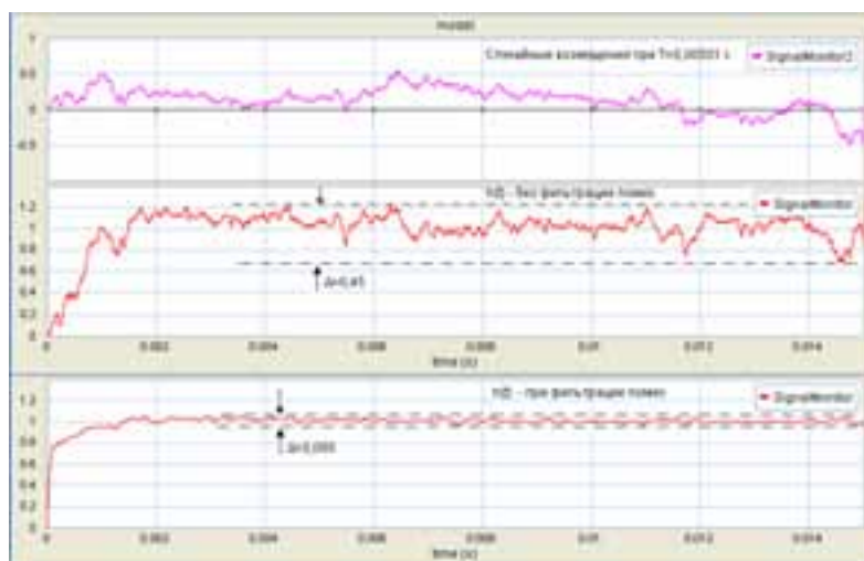
Рис. 5. Результаты моделирования работы САУ при случайных возмущениях: a – при T = 1 \cdot 10^{-4} с; b – T = 1 \cdot 10^{-5} с
