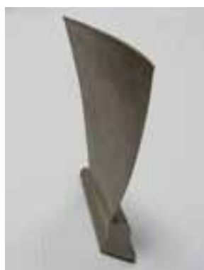
Рис. 3. Пример функциональных деталей, изготовленных с помощью технологии селективного лазерного сплавления
