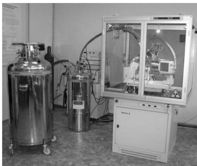
Рис. 3.2. Внешний вид рентгеновского дифрактометра Gemini-R
