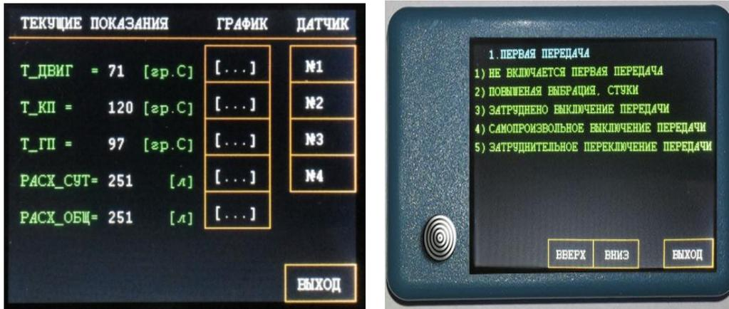
Рис. 10. Бортовая система контроля трансмиссии
