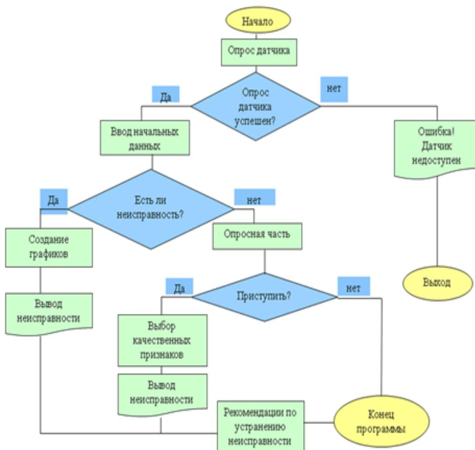
Рис. 7. Алгоритм работы бортовой системы диагностирования двигателя
