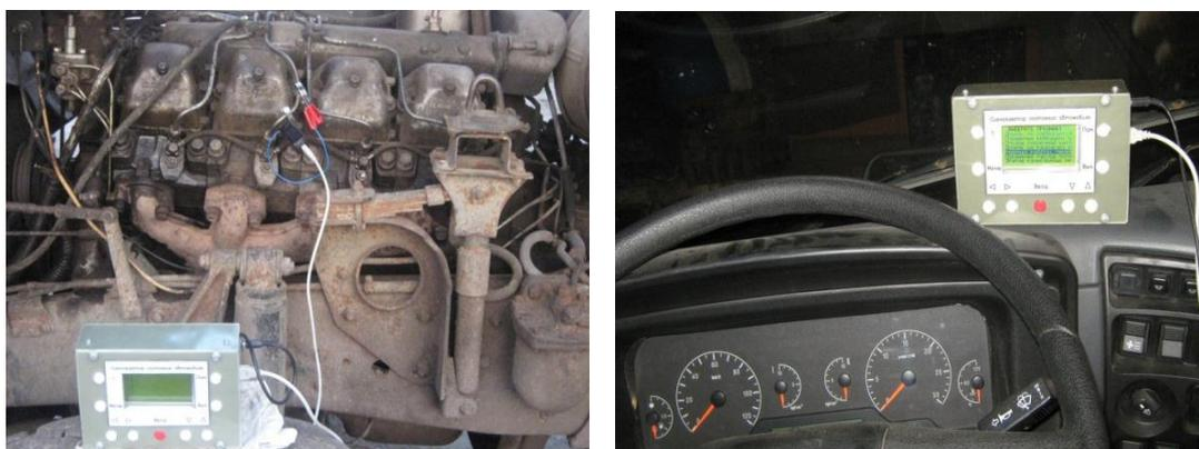
Рис. 9. Бортовая система контроля двигателя
