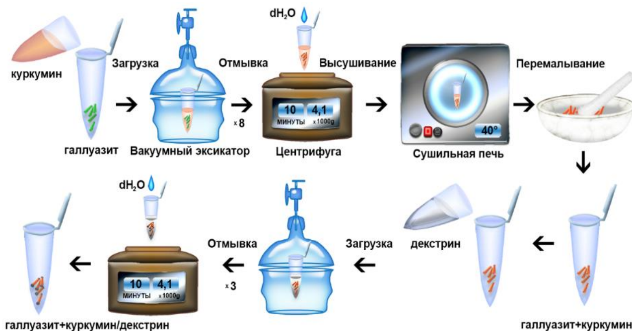
Рисунок 2. Схематическое изображение процедуры загрузки куркумина в полость нанотрубок с последующим покрытием декстриновой оболочкой. (галлуазит+куркумин) – галлуазит, загруженный куркумином; (галлуазит+куркумин/декстрин) – галлуазит, загруженный куркумином и покрытый декстрином.
