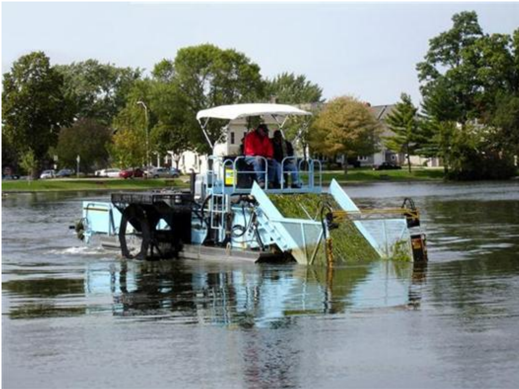
Рис. 2.2.8. Комбайн для сбора водных растений AquariusSystems™ 320 серии ( www.aquarius-systems.com )
