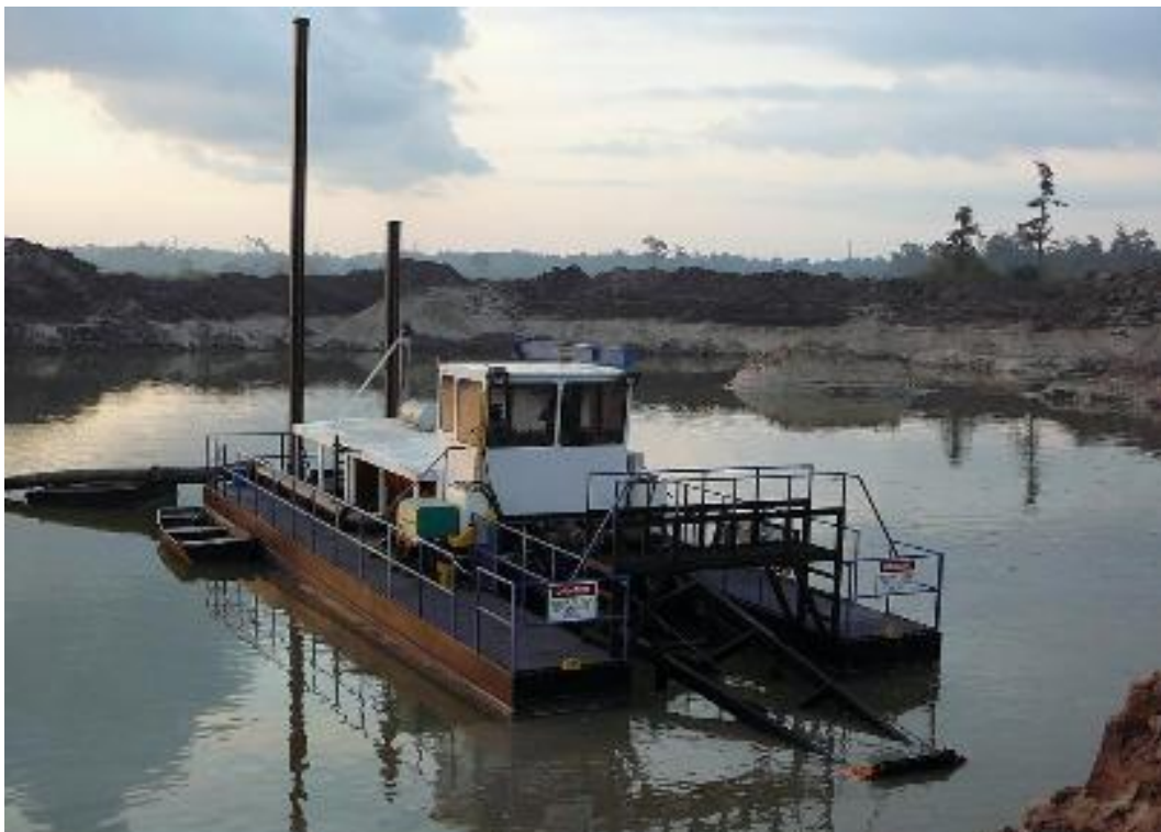
Рис. 2.1.25. Малогабаритный земснаряд с фрезерным грунторыхлителем MD-1230CS ( www.vmi-dredges.com )
