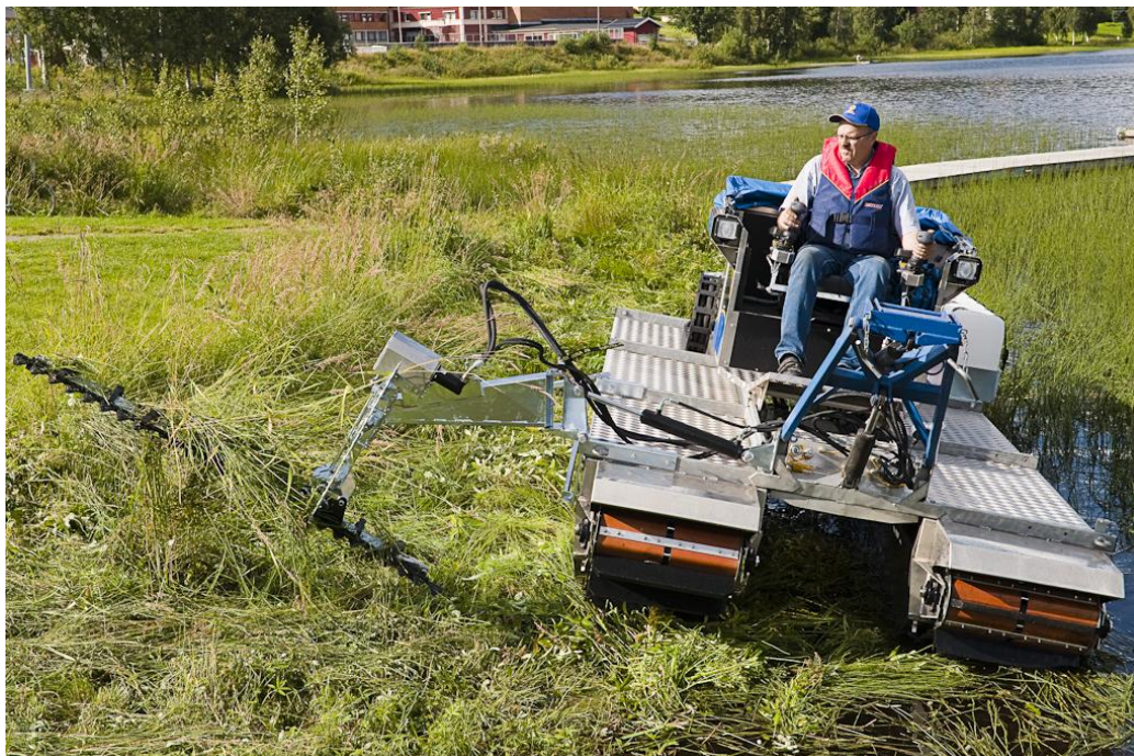
Рис. 2.2.9. Комбайн-амфибия для удаления прибрежной растительности TRUXOR™ ( www.truxorusa.com )
