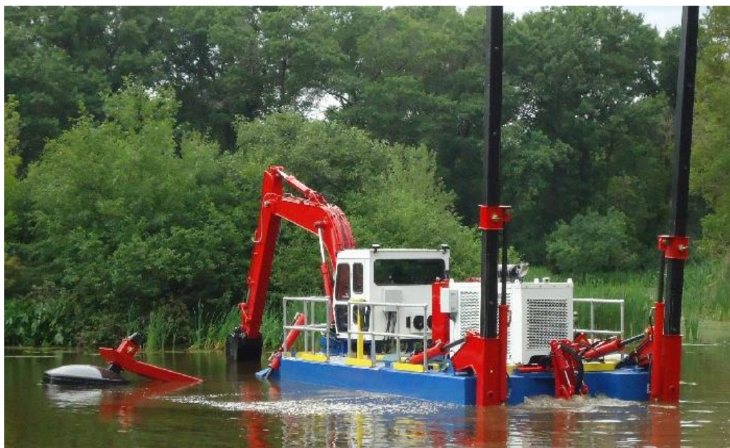
Рис. 2.1.23. Многофункциональный земснаряд MFD-1000 MudCat™ ( www.mudcat.com )
