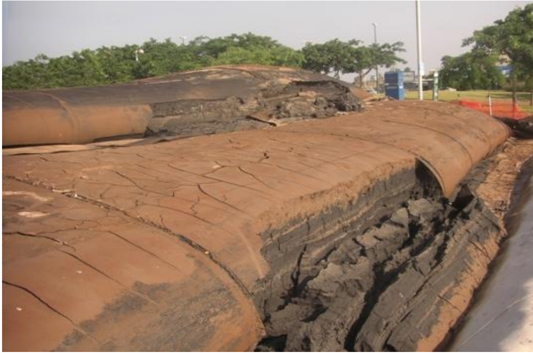
Рис. 2.1.28. Обезвоженные с помощью технологии Geotube™ донные отложения после вскрытия контейнера ( www.dewateringsolutions.net )
