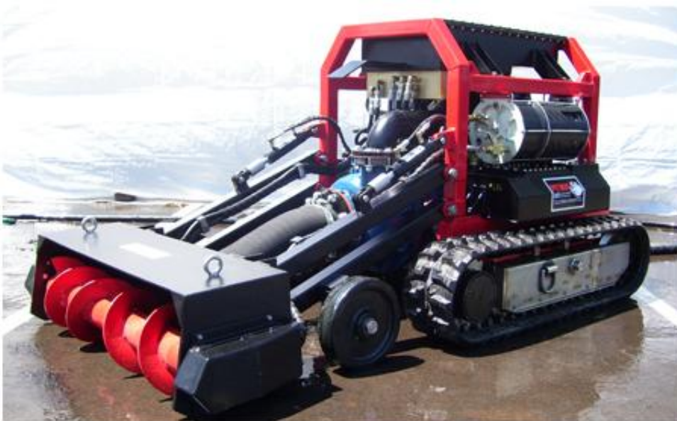
Рис. 2.1.26. Автоматизированные малогабаритные земснаряды со шнековыми грунторыхлителями: надводный PHE-40HP и подводный ROV-6PitDog™ ( www.lwtpithog.com )
