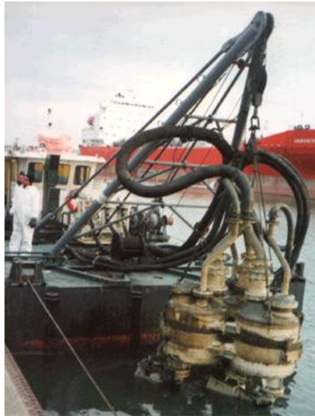
Рис. 2.1.22. Пневмонасос PNEUMA™ ( www.pneuma.lv )
