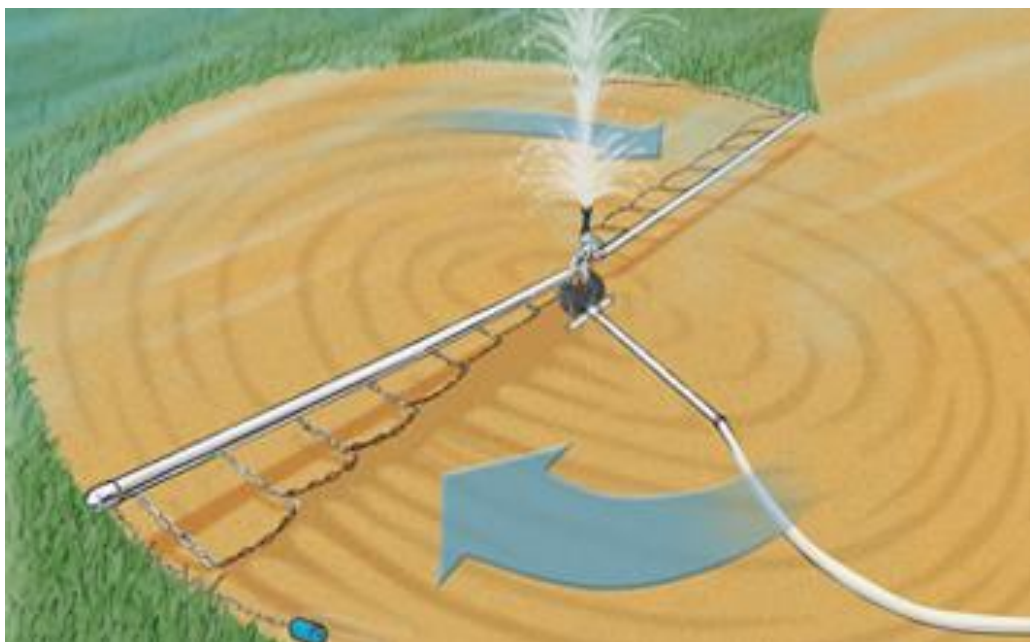
Рис. 2.2.7. Техническое средство регулирования роста водорослей в автоматическом режиме BeachGroomer™ ( www.beachgroomer.com )
