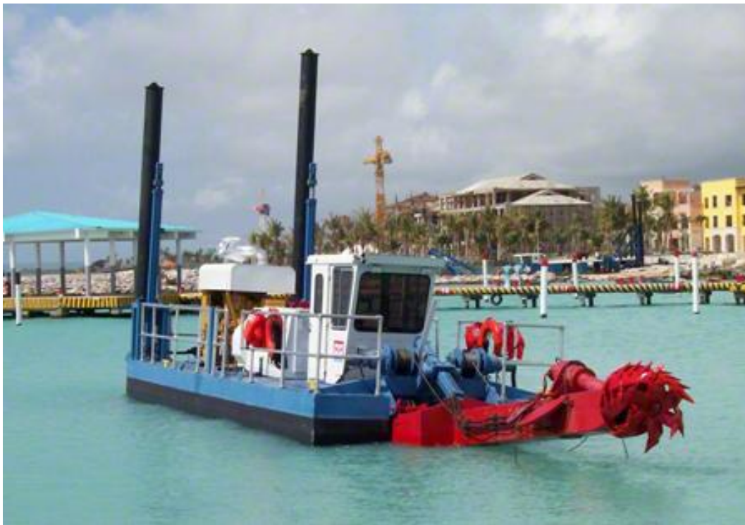
Рис. 2.1.24. Малогабаритный земснаряд с фрезерным грунторыхлителем 370HP SwingingDragon™ ( www.dredge.com )
