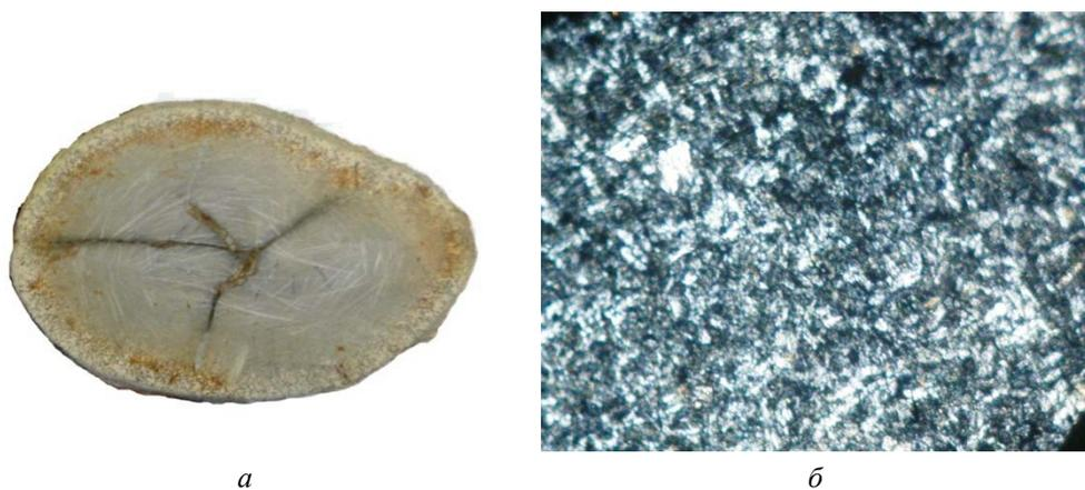
Рис. 3. Фото поверхности (*a*) и шлифа (*б*) одноактной баритовой конкреции
