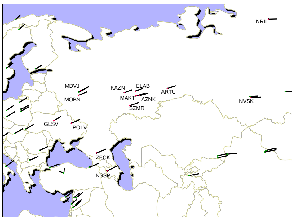
Рис. 2. Вектора векового смещения базовых станций РТ на фоне векторов векового смещения пунктов сети IGS
