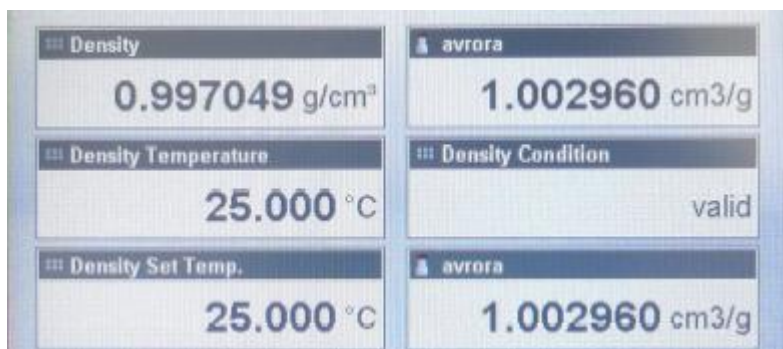
Рис. 5.2. Показания сенсорного экрана, указывающего на достижение заданной температуры.
