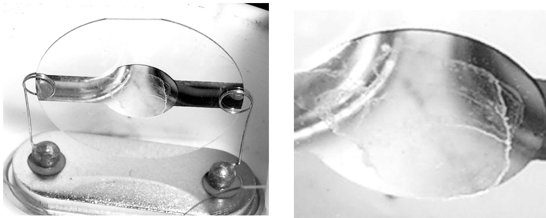
Рис. 3.5. Слева: пьезоэлектрический резонатор, справа: увеличенное изображение поверхности золотого электрода, с нанесенной на поверхность пленкой каликсарена
