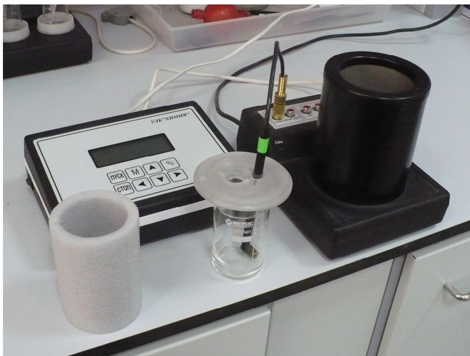
Рис. 2.6. Калориметр учебно-лабораторного комплекса (УЛК) «Химия», разработанного в Томском политехническом университете
