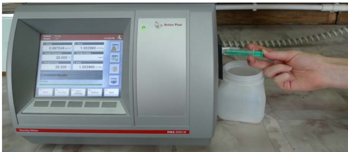
Рис. 3.1. Блок управления денситометра DMA 5000M. Стабильность поддержания температуры – 0.001°C. Точность – 5 \cdot 10^{-6} г/см 3 .
