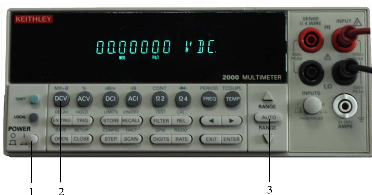
Рис. 1.9. Передняя панель мультиметра Keithley 2000 / Е. Позиции: 1 - включение / выключение прибора; 2 – включение режима измерения постоянного напряжения; 3 - включение / выключение автоматического выбора предела измерения.
