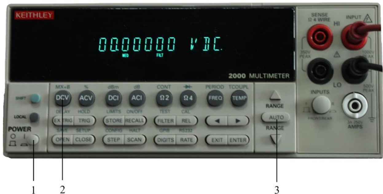
Рис. 2.1. Передняя панель мультиметра Keithley 2000/Е. Позиции: 1 – включение/выключение прибора; 2 – включение режима измерения постоянного напряжения; 3 – включение/выключение автоматического выбора предела измерения
