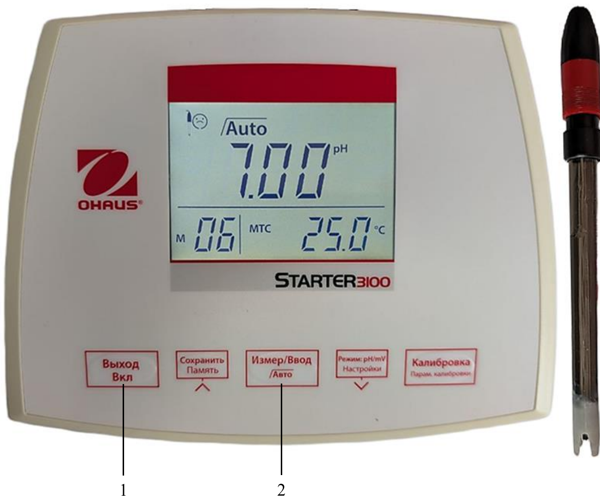
Рис. 2.2. Лицевая панель и датчик pH-метра STARTER 3100 (Ohaus). Позиции: 1 – включение/выключение прибора; 2 – переключение режима измерения
