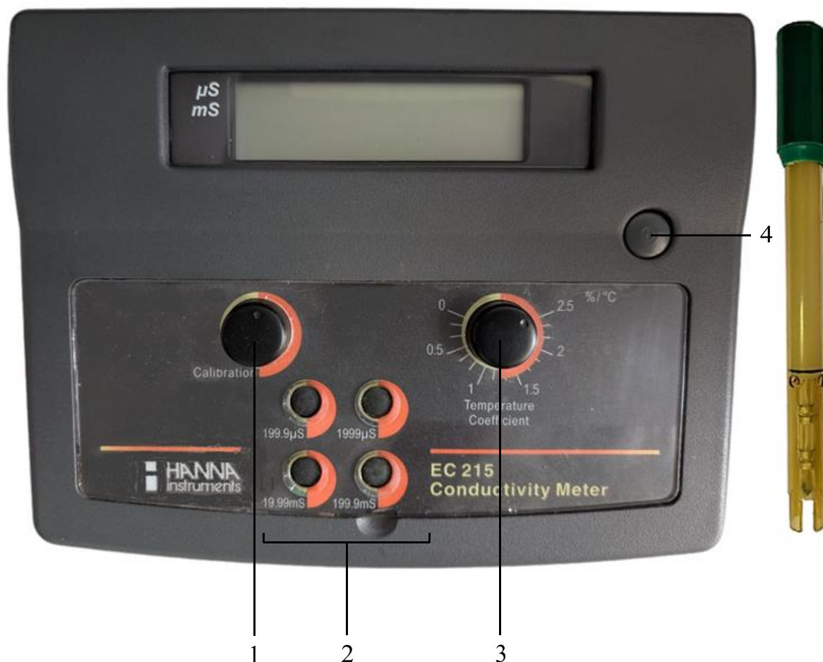
Рис. 1.7. Лицевая панель и датчик кондуктометра ЕС 215. Позиции: 1 – калибровка прибора; 2 – диапазоны измерений \kappa ; 3 – установка температурного коэффициента; 4 – включение / выключение кондуктометра
