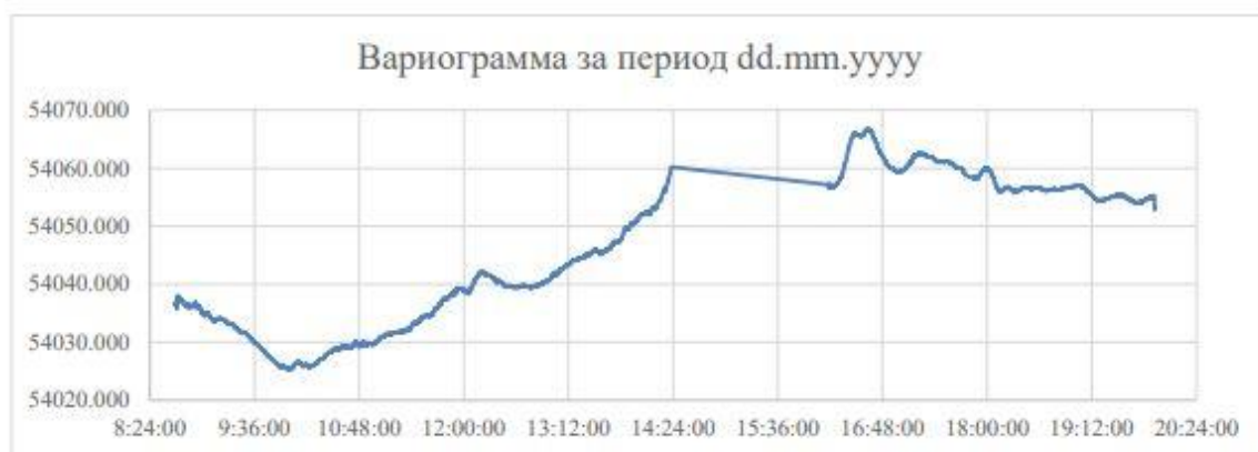
Рис. 6. Пример построения графиков вариации магнитного поля
