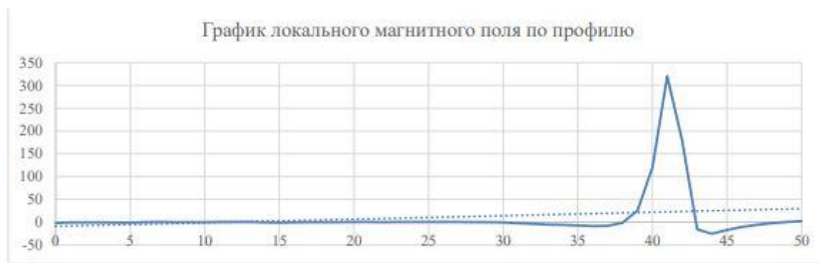
Рис. 7. Пример построения графиков аномального объекта вдоль профиля
