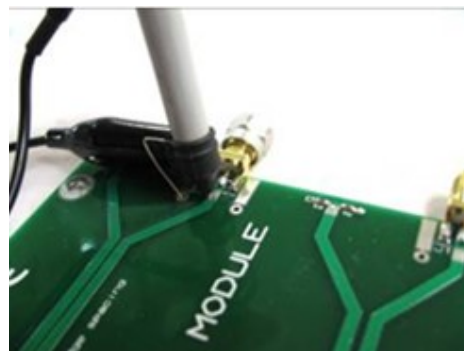
Рис. 9. Исследование напряжения для связанной линии
