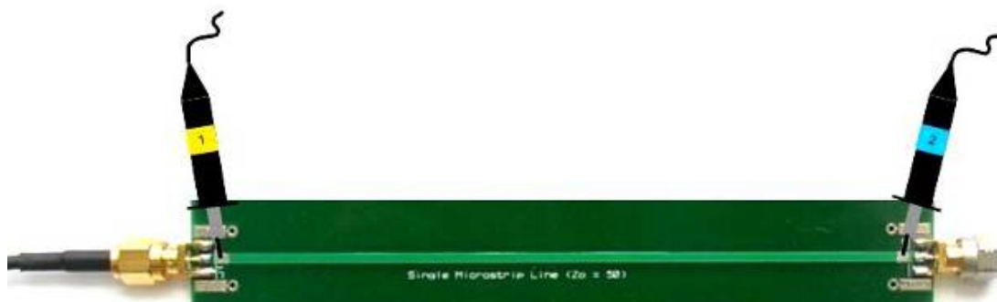
Рис. 13. Измерение задержки распространения в микрополосковой линии
