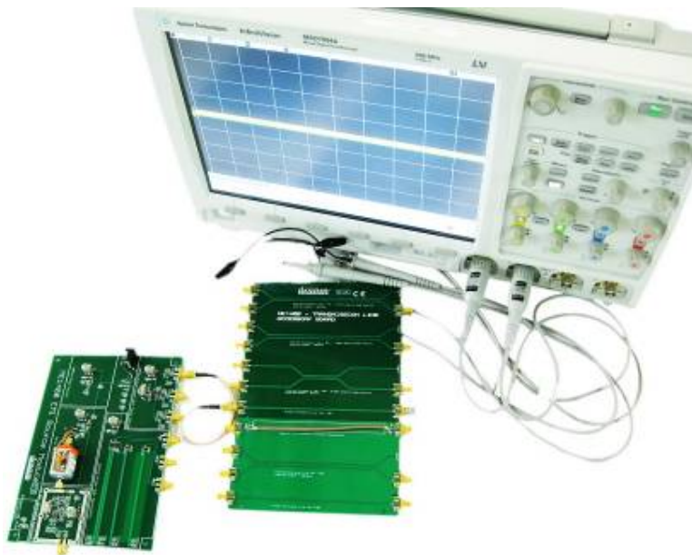
Рис. 10. Базовая установка для измерения временной области
