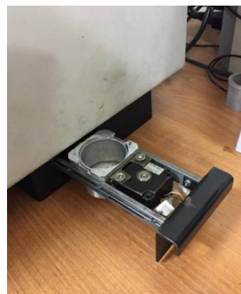
Рис. 16. Устройство для ввода образца
