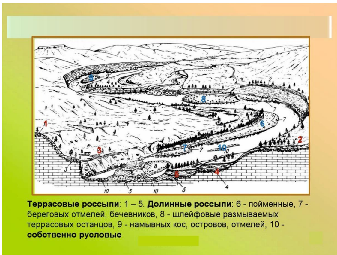
Рис. 14. Схема расположения россыпей различных типов в долине реки Концентрация ценных минералов в аллювиальных россыпях осуществляется в
