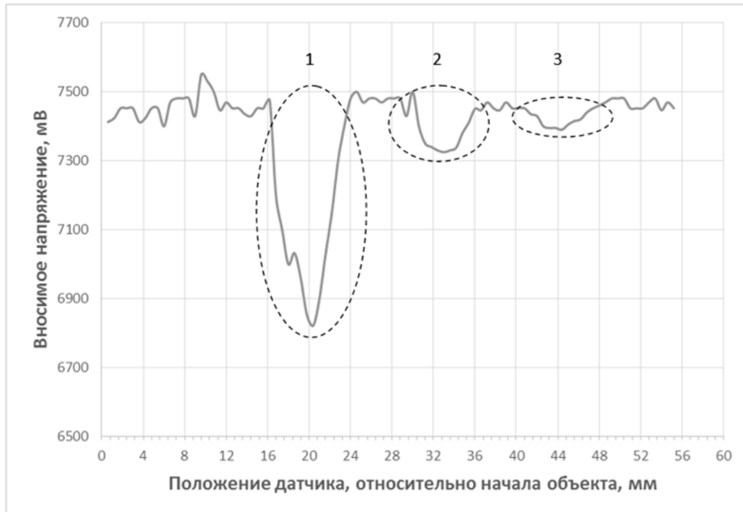
Рис. 3. Результаты сканирования пластины №1: 1, 2, 3 – номера дефектов
