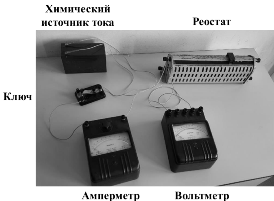
Рис. II.7. Фотография экспериментальной установки для определения внутреннего сопротивления и ЭДС источника тока
