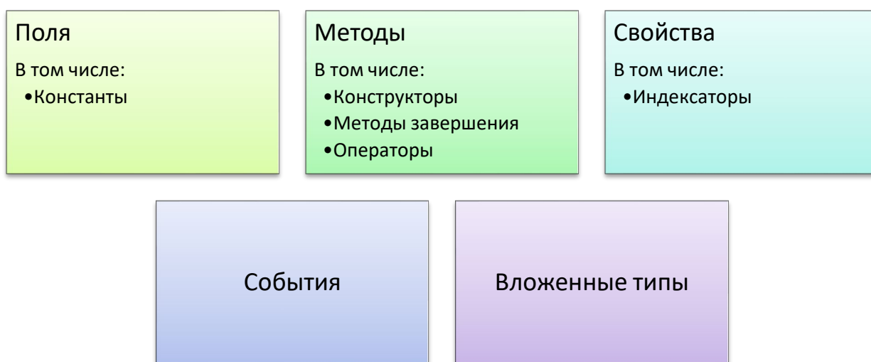
Рис. 1. Разновидности элементов класса в C#
