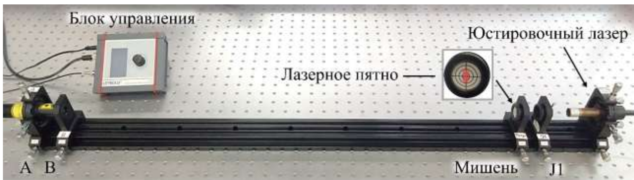
Рис. 16. Внешний вид экспериментальной установки. А – диодный лазер, В – коллиматорная линза, J1 – ирисовая диафрагма
