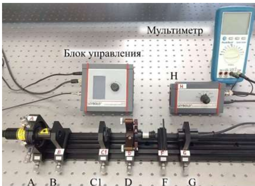
Рис. 20. Внешний вид экспериментальной установки, F – светофильтр RG1000
