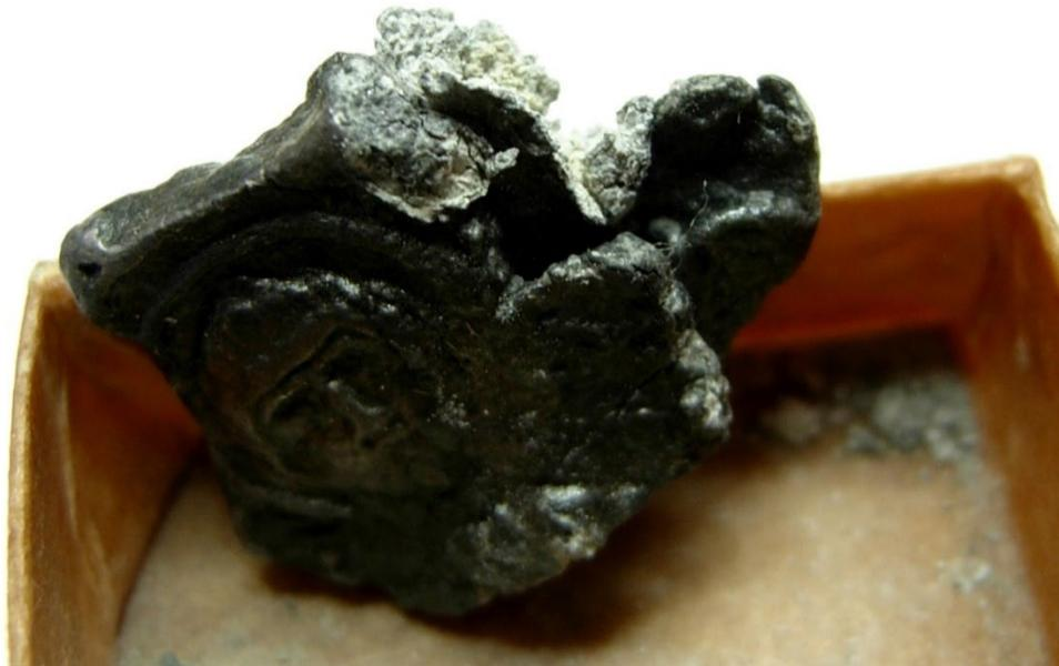
*Рис. II.11. Диагностический признак активной коррозии свинца
