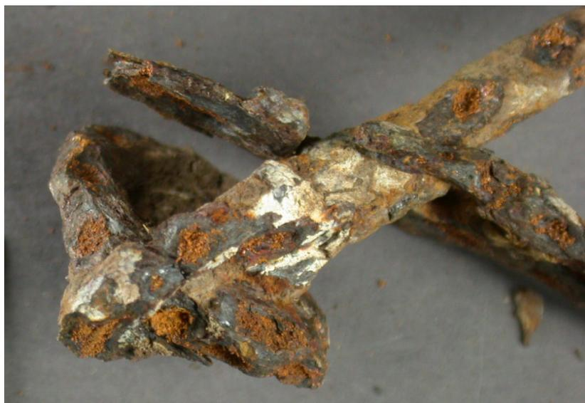
*Рис. II.9. Диагностический признак активной коррозии железа
