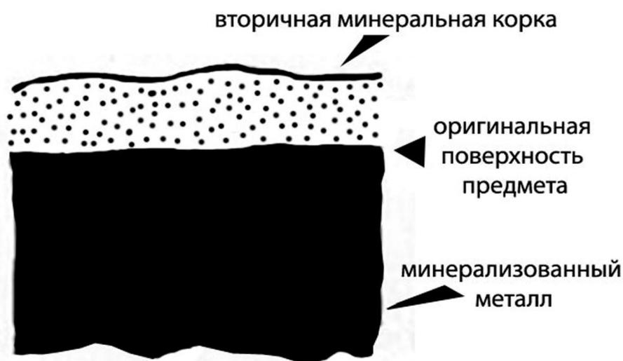
*Рис. II.8. Полная минерализация археологических предметов из металла*
