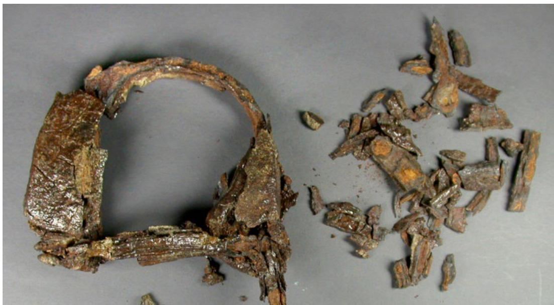
*Иллюстрация III.4. Очищенный и законсервированный железный археологический предмет после нескольких лет хранения без стабилизирующей обработки (фото М.Г. Боровиковой)*
