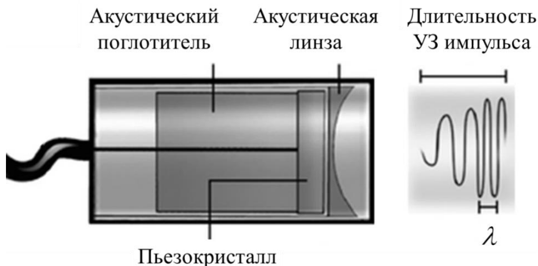
Рис. 24. Схематическое устройство ультразвукового преобразователя
