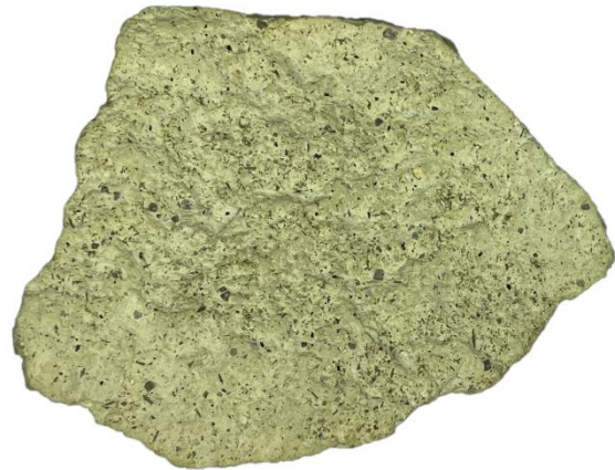
Риолит (вулканический аналог гранита). Стекловатая структура, порода содержит мелкие вкрапленники кварца и плагиоклаза
