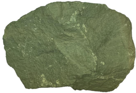
Фонолит (эффузивный аналог нефелиновых сиенитов), тонко-, мелкозернистой структуры. Порода недонасыщена кремнеземом – отсутствует кварц и другие кристаллы кремнезема
