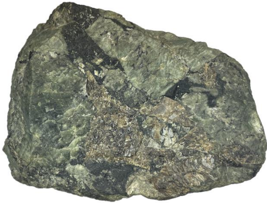
Хибинит. Кольский п-в, Хибины. Крупно-, гигантозернистая порода, минеральный состав: нефелин, эгирин, роговая обманка, арфведсонит
