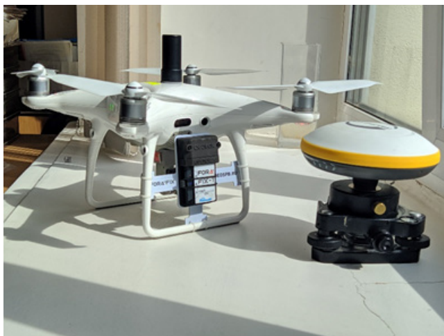
Рис. 2. БПЛА DJI Phantom 4 Pro v2 с внесенными изменениями.
