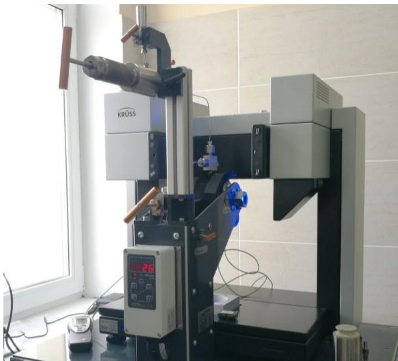
Рис. 5. Внешний вид прибора определения формы капли DSA100 для определения краевого угла смачивания
