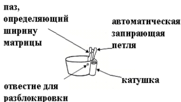
Рис.18.Схема устройства Auto Matrix
