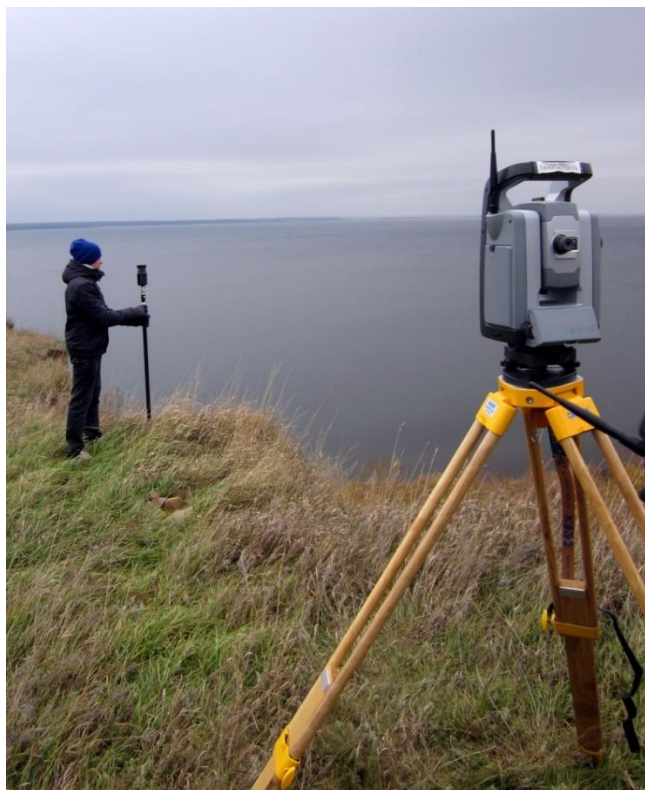
Рисунок 1. Роботизированный тахеометр Trimble VX с функцией лазерного сканирования.
