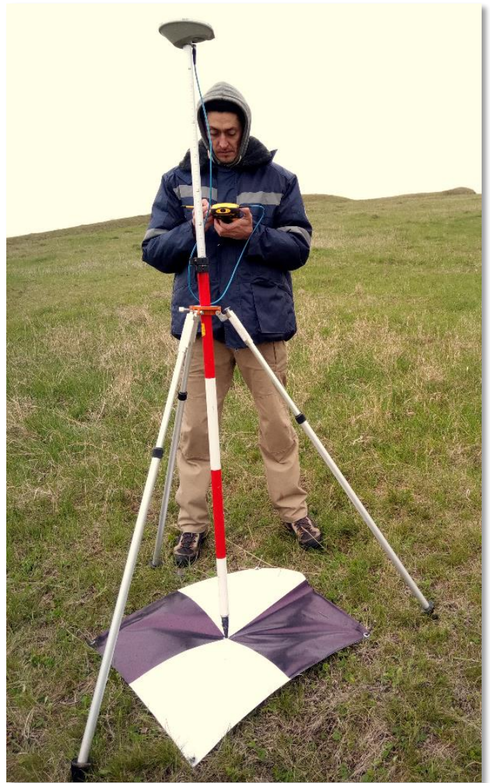
Рисунок 8. Квадрокоптер DJI Phantom 4 (а), процесс съемки специальной марки ГНСС-приемником (б), полетное задание в приложении DroneDeploy (в)
