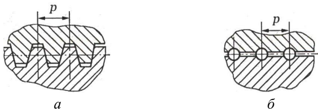
Рисунок 16- Передача с трением скольжения (а), качения (б)
