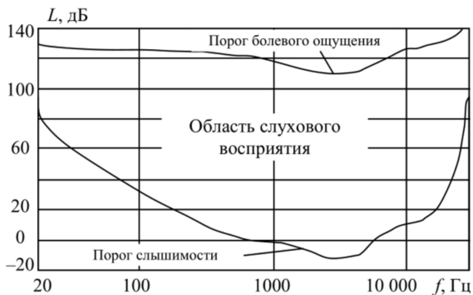
Рис. 7. Верхняя линия отмечает границу, выше которой звук вызывает болевые ощущения; нижняя линия отмечает порог слышимости
