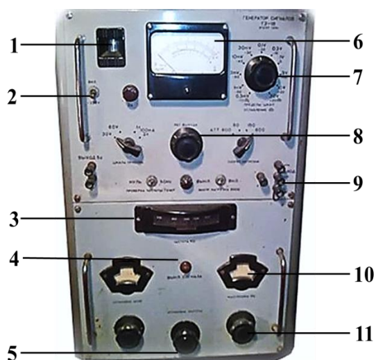
Рис. 6. Генератор сигналов низкочастотный ГЗ-18
