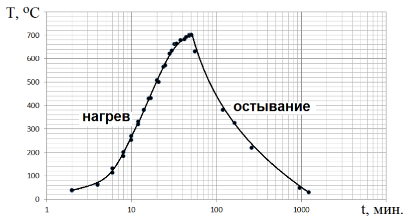
Рисунок 1. Температурный режим работы муфельной печи
