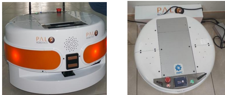
Рис. 1. Робот PMB-2 во время движения (слева); робот PMB-2 подключен к док-станции и находится в процессе зарядки, вид сверху (справа)
