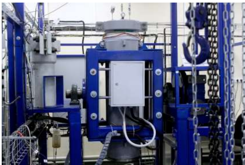
Рис.1.1 – Фото установки физико-химического моделирования процесса паротеплового дренажа
