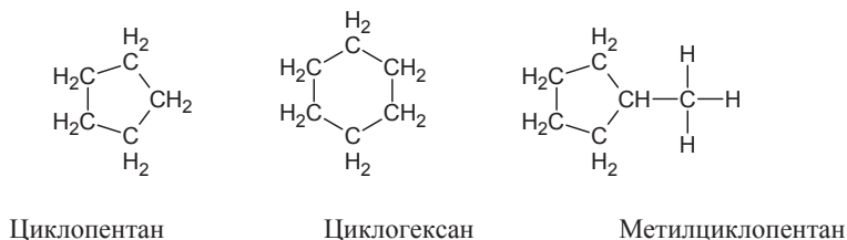
Рис. 2.2 Химические формулы нафтеновых (циклоалкановых) углеводородов: а) циклопентан, б) циклогексан, в) метилциклопентан.
