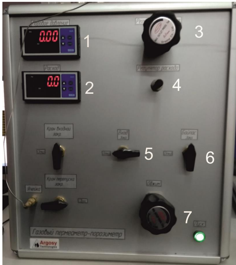
Рисунок 19. Управляющая панель прибора Пласт-215АТМ, 1- манометр порового давления, 2- значение расходомера, 3-регулятор порового давления, 4- регулятор расхода, 5- входной кран, 6- байпас, 7- регулятор обжима.
