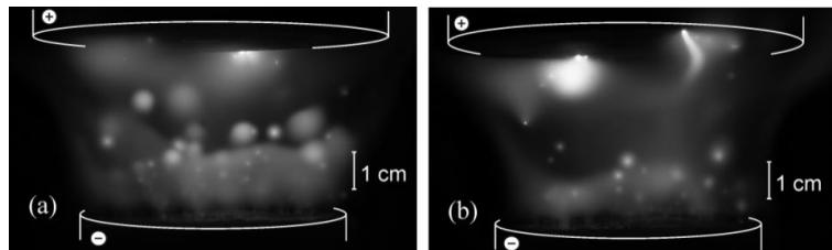
Рис. 2. Моментальные фотографии газового разряда. Катод – водный раствор NaCl, анод – медь.
