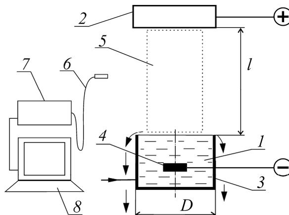
Рис. 1. Газоразрядный узел. Стрелками указано направление движения электролита.
