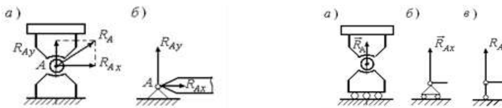
Рисунок 9-Шарнирно-неподвижная опора Рисунок 10-Шарнирно-подвижная опора
