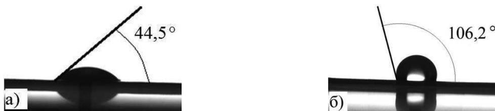
Рисунок 2 - Изображения смачиваемости капель дистиллированной воды мембраны: а) исходной из нейлона; б) динамической нейлон-ПС (содержание ПС – 4,1%) [10]
