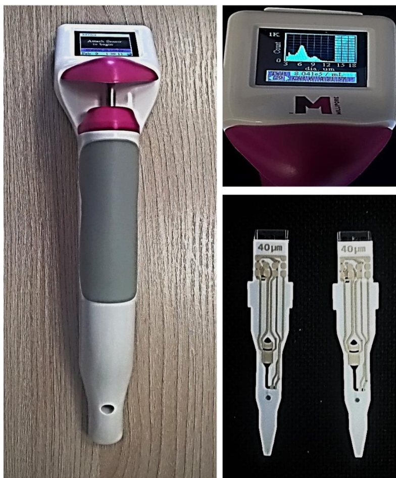
Рис. 1. Счетчик клеток Scepter™ 2.0 Handheld Automated Cell Counter с сенсорными наконечниками на 40 мкл (Merck Millipore)
