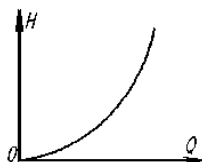
Рис. 4. 2. Характеристическая кривая простого трубопровода при турбулентном режиме
