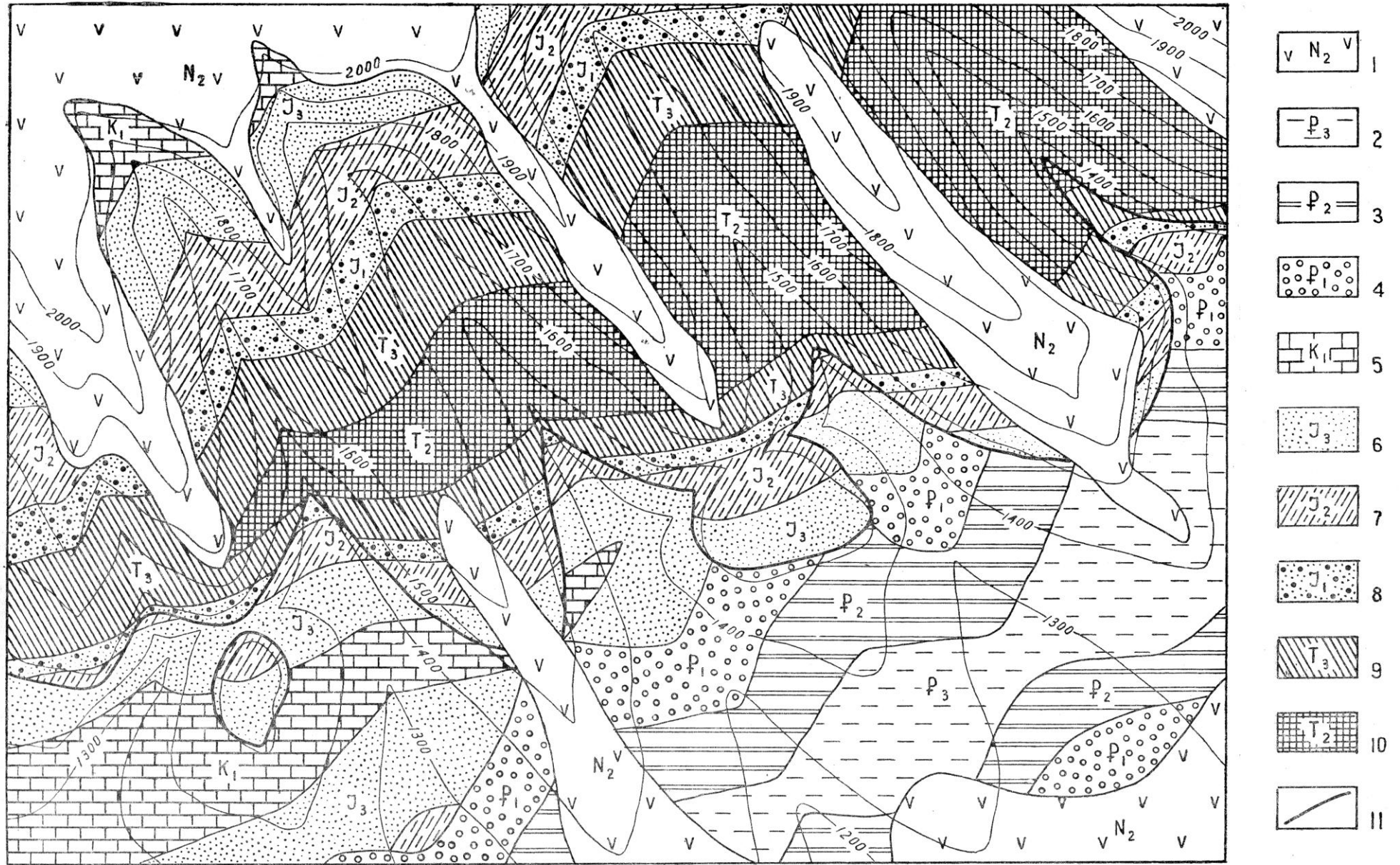
1 — андезиты; 2 — глины; 3 — песчаники и алевролиты; 4 — конгломераты; 5 — известняки; 6 — полимиктовые песчаники; 7 — алевролиты и аргиллиты; 8 — полимиктовые песчаники и гравелиты; 9 — туфоалевролиты; 10 — диабазы; 11 — разрывное нарушение
