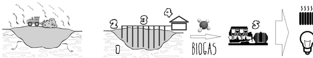
Рис. 1. Типовая схема утилизации свального газа, где
