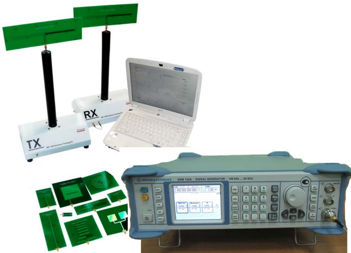
Рис. 1. Состав оборудования: учебный набор ME1300, генератор сигналов R&S®SMB100A, компьютер
